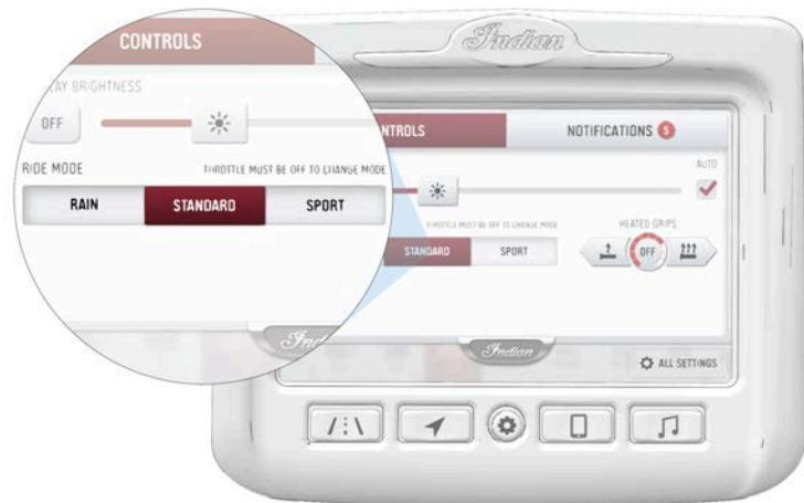
Puede elegir entre tres modos de conducción: «Rain», «Standard» o «Sport» (lluvia, estándar o deportivo) para obtener una experiencia personalizada para su estilo de conducción. El mapa de aceleración para cada modo de conducción fue diseñado considerando una aplicación específica, lo que produce una motocicleta con tres personalidades diferentes.
